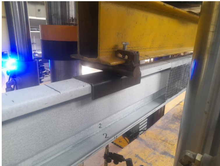
Rys. 4.3 Podkładki z ceowników między belką a trawersem
