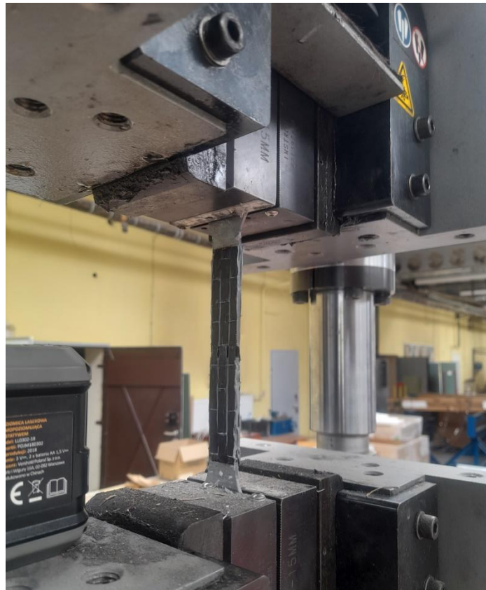
Rys. 3.6 Stanowisko badawcze – próbka serii SK1 w uchwytach maszyny wytrzymałościowej
