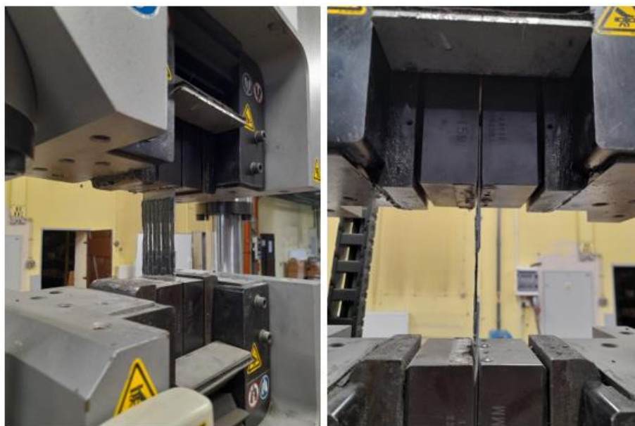
Rys. 3.13 Połączenie klejone w szczękach maszyny wytrzymałościowej
