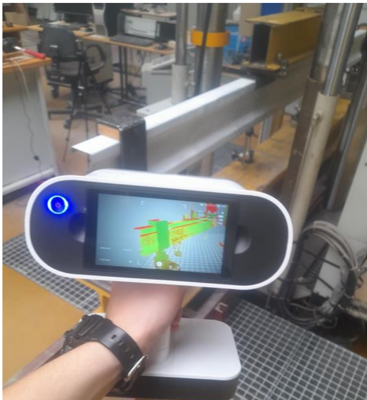
Rys. 4.6 Pomiar geometrii belki za pomocą skanera 3D Artec Leo
