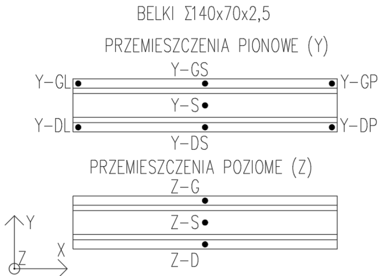
Rys. 4.26 Lokalizacja punktów na powierzchni środnika dla belek \Sigma 140 \times 70 \times 2,5
