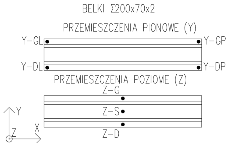
Rys. 4.25 Lokalizacja punktów na powierzchni środnika dla belek \Sigma 200 \times 70 \times 2
