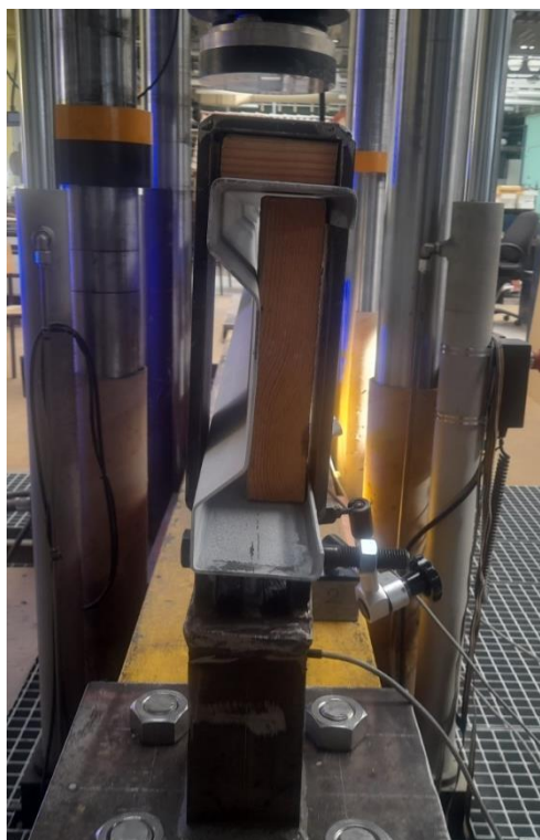
Rys. 4.5 Przepona na podporze w postaci drewnianego klocka
