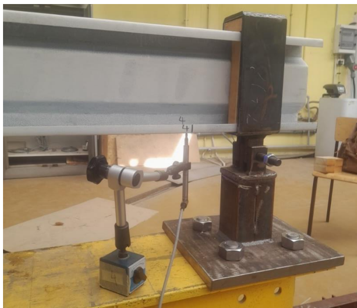
Rys. 4.4 Podpora „widelkowa” i czujnik indukcyjny
