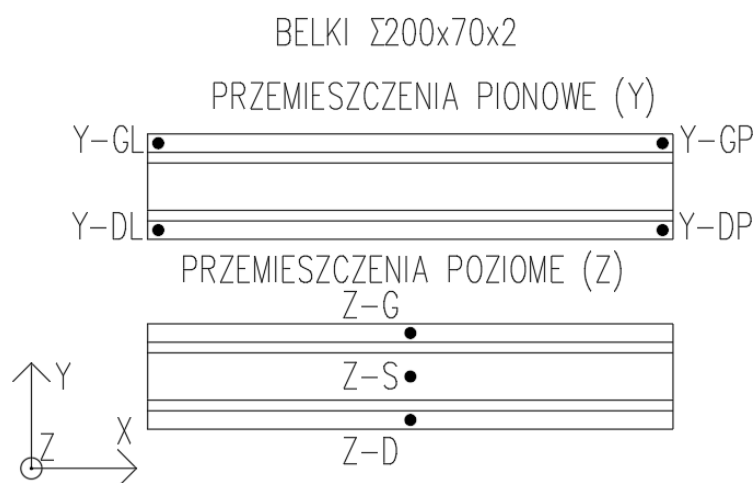
Rys. 6.4 Lokalizacja punktów na powierzchni środnika dla belek \Sigma 200 \times 70 \times 2
