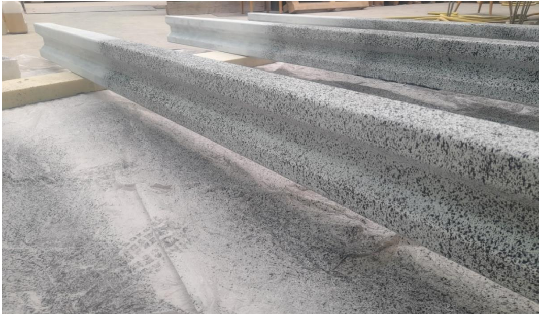
Rys. 4.7 Niejednorodny wzór wykonany na badanych belkach dla pomiarów systemem ARAMIS
