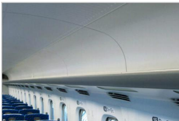
Rysunek 12. Sufit pociągu Schinkansen wykonany z materiału sandwichowego [61]
