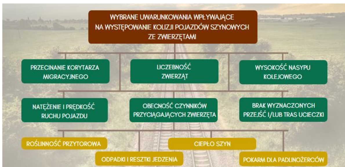
Rys. 2.10. Najważniejsze czynniki wpływające na występowanie kolizji pojazdów szynowych ze zwierzętami
