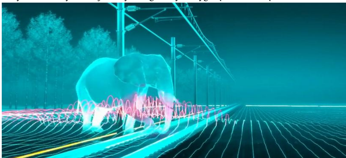
Rys. 6.9. Wizualizacja działania systemu Gajraj z użyciem przewodów światłowodowych w celu detekcji słońi zbliżających się do torów kolejowych [228]
