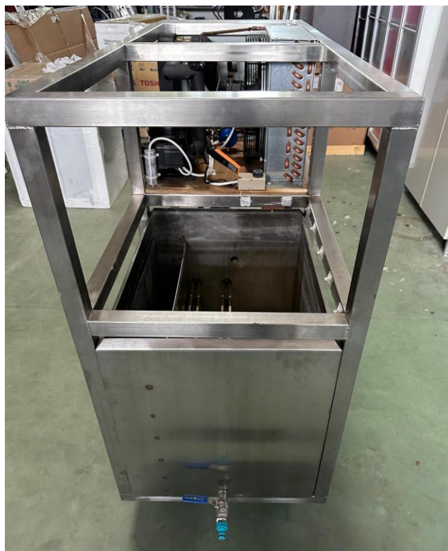
Rysunek 35 Stanowisko badawcze wytwornicy wody ziemnej - widok od zbiornika-bufora ciepła
