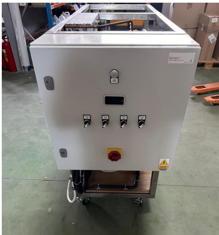
Rysunek 33 Stanowisko badawcze wytwornicy wody ziębniczej - widok szafy zasilająco-sterującej
