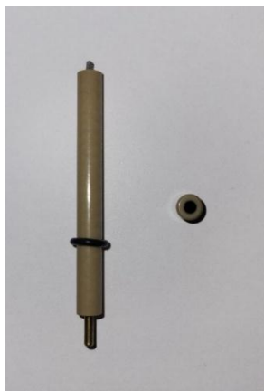
Rys. 41. Zdjęcie elektrody GC ze zdejmowaną końcówką, której użyto do pomiarów AFM.
