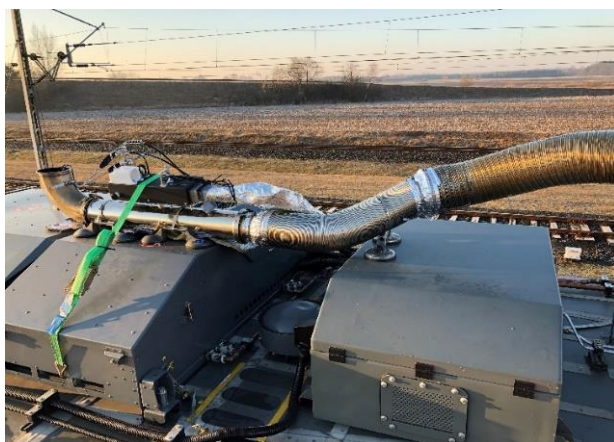
Rys. 6.4. Warunki prowadzenia badań: a) przepływomierz zamontowany na dachu pojazdu, b) analizator spalin AxionR/S+ ustawiony wewnątrz pojazdu
