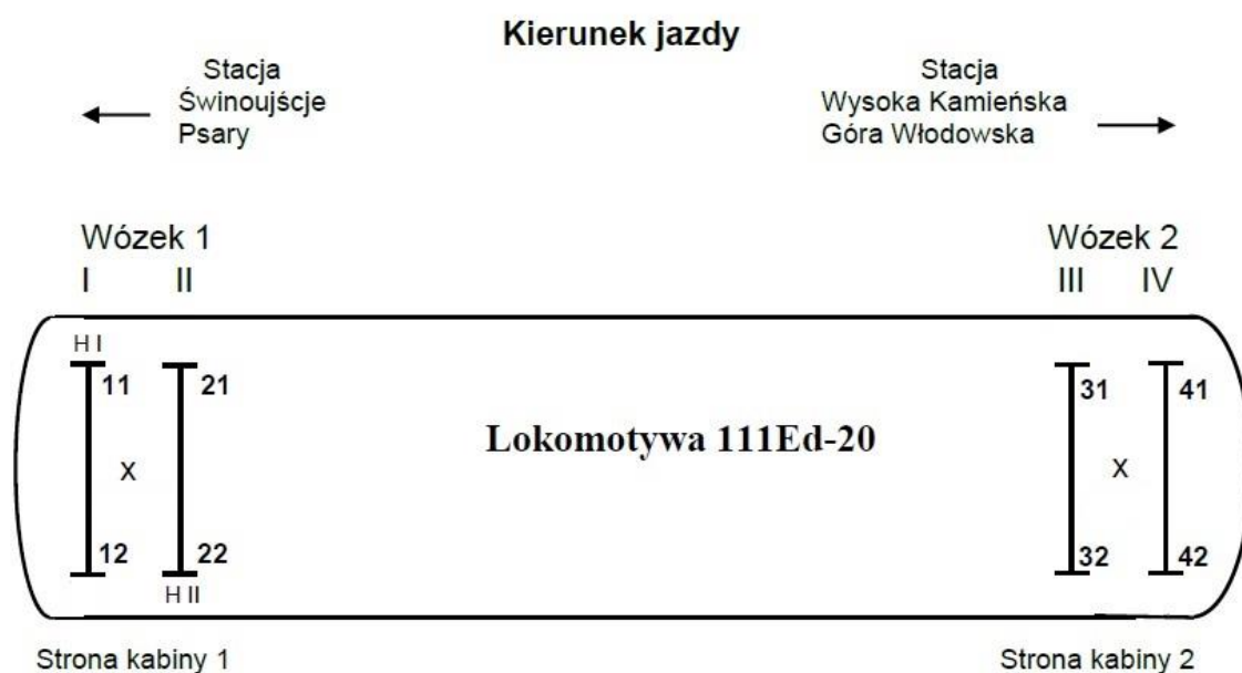
Rys. 7.25 Rozmieszczenie punktów pomiarowych na lokomotywie 111E, oprac. własne na podst. [24]
