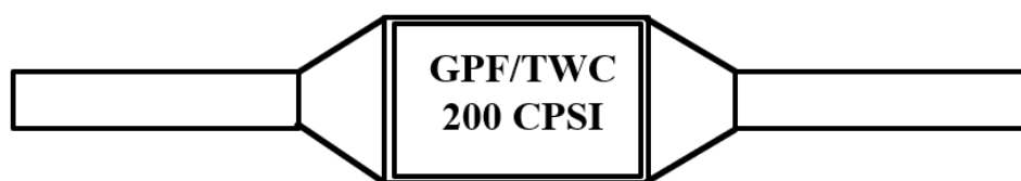
Rys. 9.17. Schemat układu oczyszczania gazów wylotowych z prototypowym nośnikiem metalowym 200 CPSI
