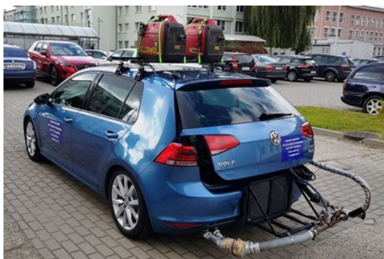
Rys. 7.1. Pojazd stanowiący obiekt badań w warunkach rzeczywistych
