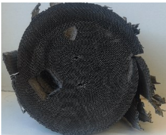
Rys. 5.13. Metalowy nośnik reaktora katalitycznego wykorzystany do analizy rentgenowskiej i recyklingu [32]
