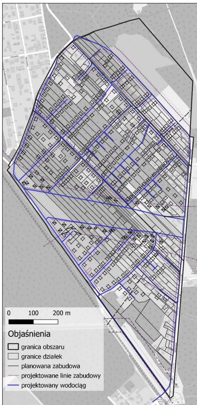
Ryc. 45 Plan podziału działek z projektem wodociągu na podstawie Planu Zagospodarowania Przestrzennego dla osiedla Mokry Ług.
