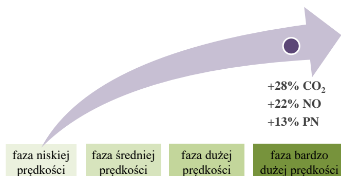
Rys. 3.11. Wpływ wiatru na emisję poszczególnych składników spalin w teście WLTC [56]
