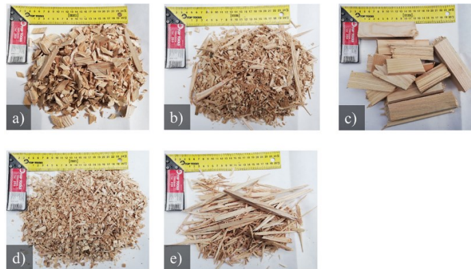
Rys. 5.3.2.9. Zrębki z rębaków o różnych mechanizmach tnących: a) tarczowy (X), b) bębnowy (W), walcowy (Y), tarczowy (Z2), bębnowy (Z1)
