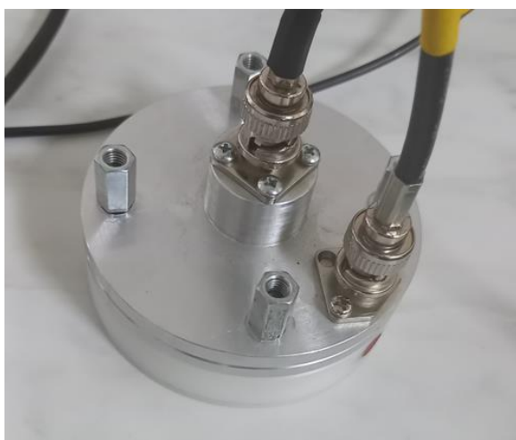
Rys. 4.10. Fotografia układu elektrod użytego do wyznaczenia przenikalności elektrycznej materiałów stałych [materiały własne]
