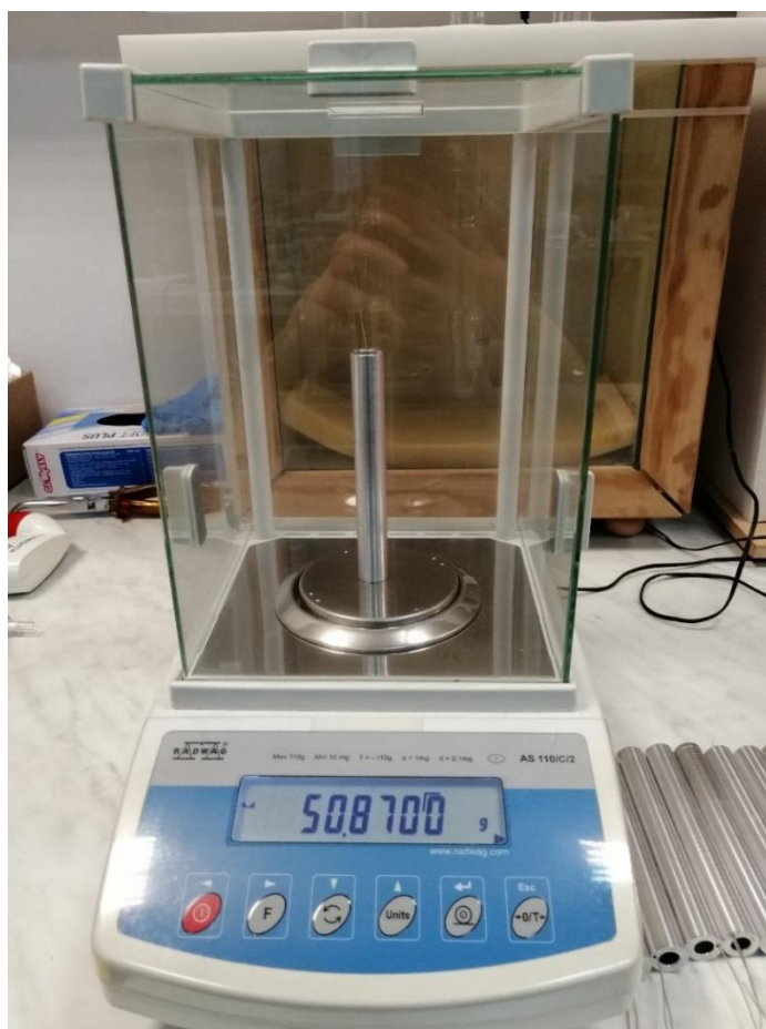
Rys. 4.3. Fotografia wagi RADWAG AS 110/C/2 używanej do określenia masy próbek [materiały własne]
