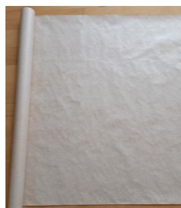
Rys. 2.7. Nomex ® 910; a) przekrój poprzeczny, b) fotografia arkusza użytego w badaniach [materiały własne]
