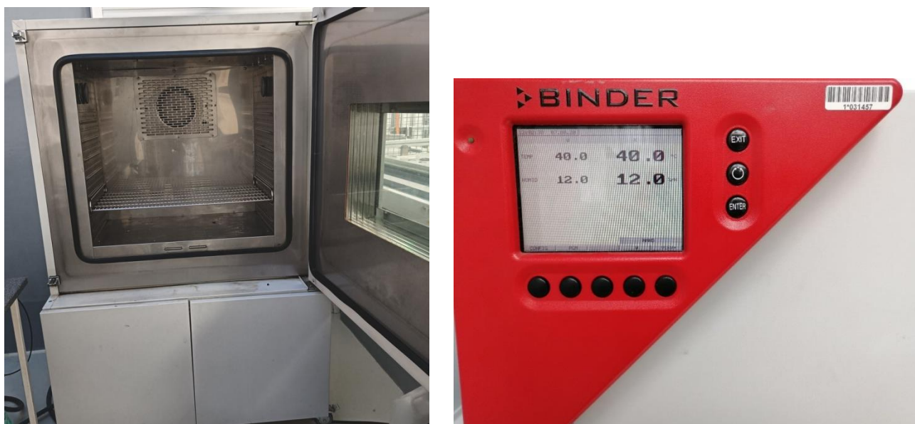
Rys. 4.4. Fotografie komory klimatycznej BINDER MKF240 E3; a) wygląd zewnętrzny, b) panel sterowniczy z ustawionymi parametrami klimatycznymi [materiały własne]
