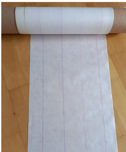
Rys. 2.6. Fotografia materiału Nomex ® 926 dostarczanego przez producenta w postaci rolki [materiały własne]
