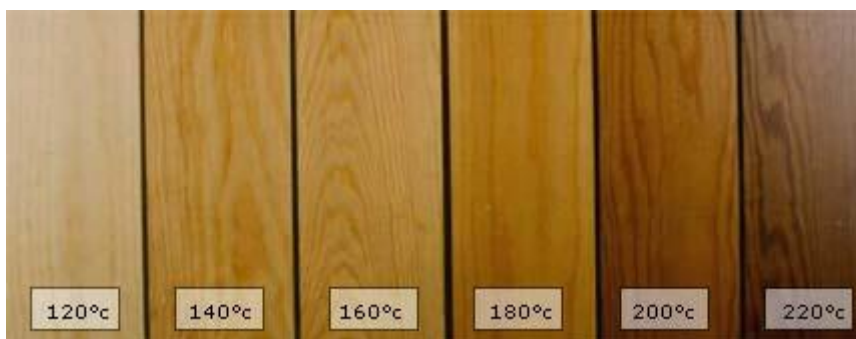
Rysunek 15. Zmiana barwy drewna poddanego modyfikacji termicznej [50]
