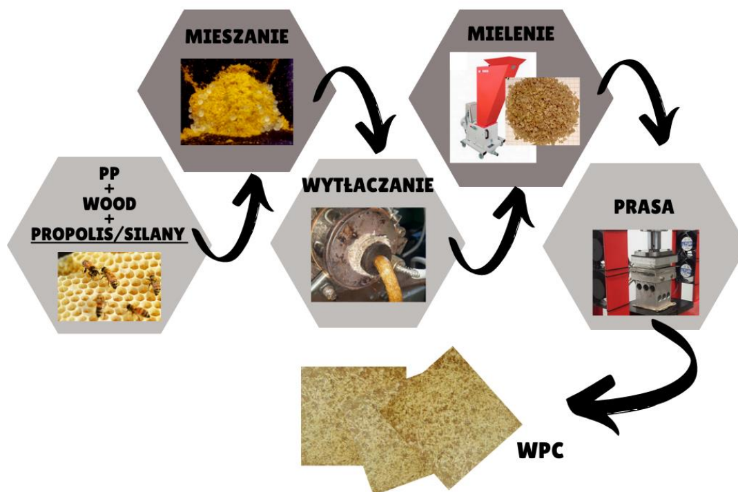
Rysunek 28. Schemat otrzymywania materiałów kompozytowych typu WPC
