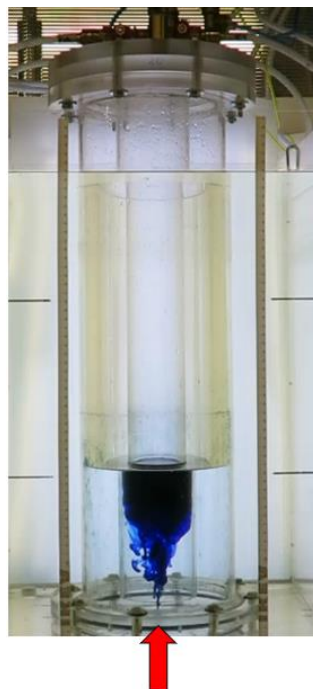
Rys. 59. Wprowadzenie barwnika do mieszalnika hydraulicznego.
