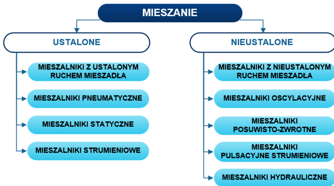
Rys. 1. Podział mieszalników ze względu na występowanie mieszania ustalonego i niestabilnego.
