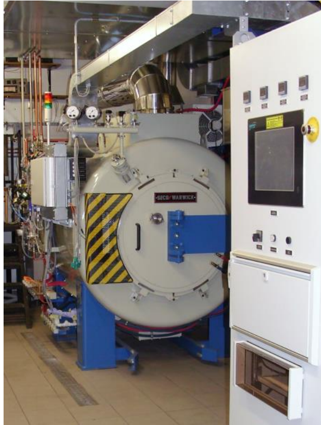
Rys. 1.7 Przemysłowy piec typu VTR (Laboratorium Obróbki Ciepłno-Chemicznej, Instytut Maszyn Roboczych i Pojazdów Samochodowych, Politechnika Poznańska); zdjęcie własne
