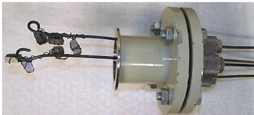
Rys. 1.9 Port do poboru próbek po azotowaniu metodą ZeroFlow w piecu typu VTR; zdjęcie własne
