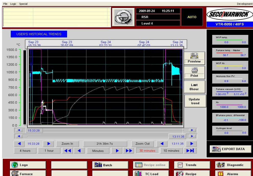
Rys. 1.5 Przebieg procesu azotowania metodą ZeroFlow w piecu przemysłowym [41]
