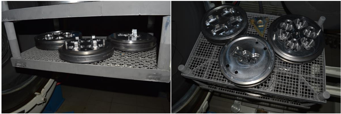
Rys. 4.10 Matryce na dwóch poziomach kosza wsadowego przed procesem azotowania metodą ZeroFlow w piecu typu VTR, laboratorium Instytutu Maszyn Roboczych i Pojazdów Samochodowych, Politechnika Poznańska [zdjęcia własne]
