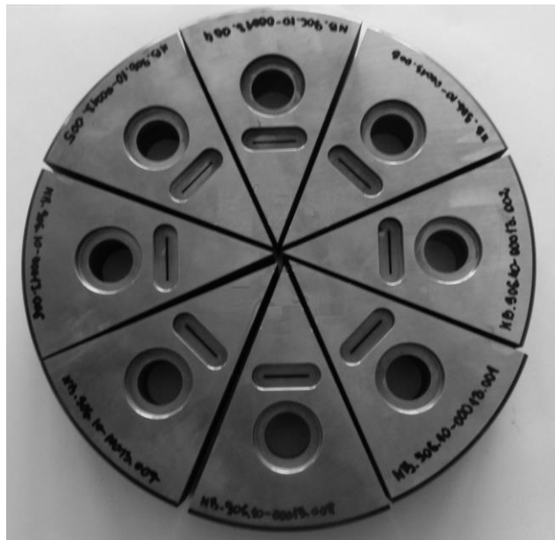
Rys. 3.1 Próbki w kształcie wycinków matrycy [88]
