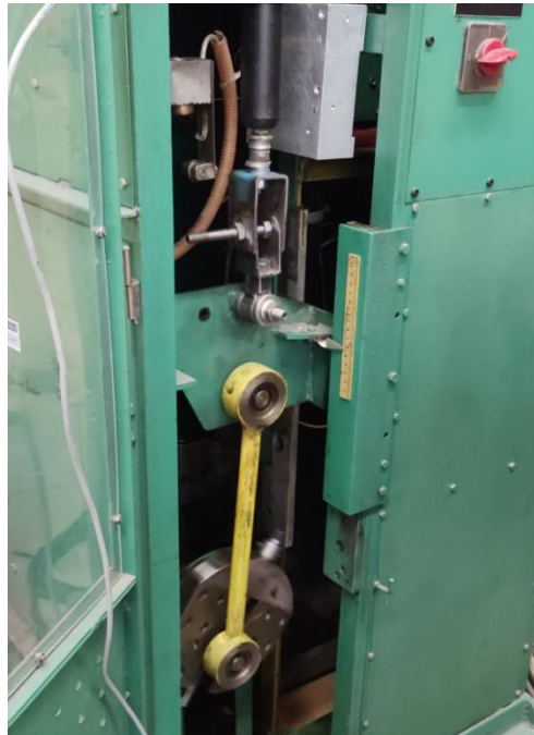
Rys. 6.24 Zdjęcie z badań stanowiących charakterystyki amortyzatora
