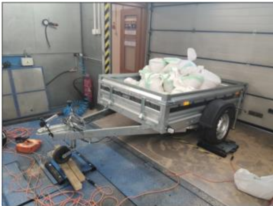
Rys. 6.21 Badanie sztywności zawieszenia. Wagi znajdują się pod kołami i dyszlem przyczepki.
