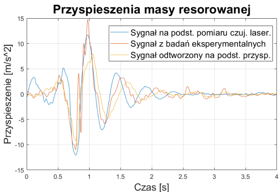
Rys. 5.15 Przyspieszenia masy resorowanej dla wymuszenia zdeterminowanego
