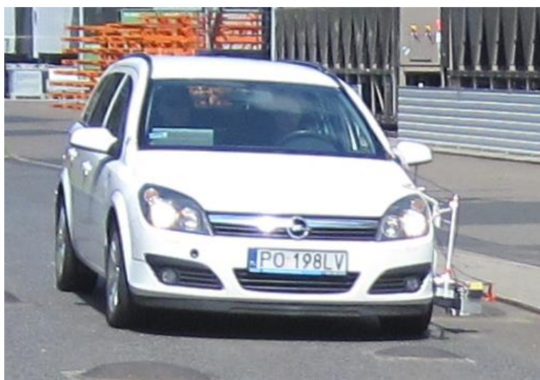
Rys. 3.1 Używany w badaniach eksploatacyjnych pojazd badawczy. Po lewej stronie widać czujniki laserowe używane do pomiaru metodą dynamiczną
