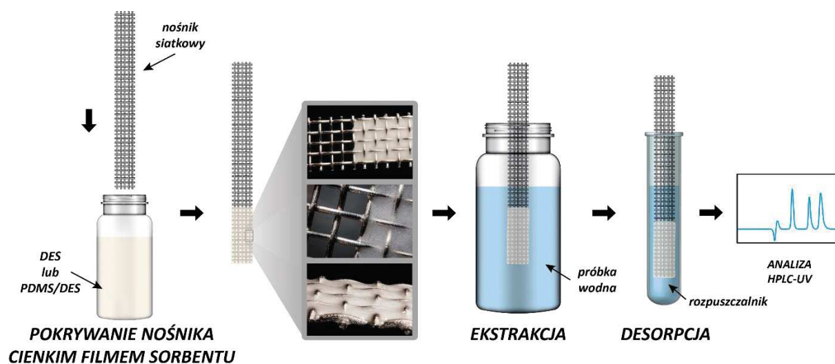
Rys. 10. Schemat proponowanej techniki DES-TF-SPME [H8-H11]
