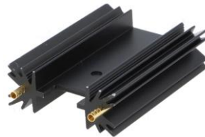
Rysunek 76: Radiator SK 104 50,8 STC o rezystancji termicznej 9 K/W z diodą FFSH10120A.
