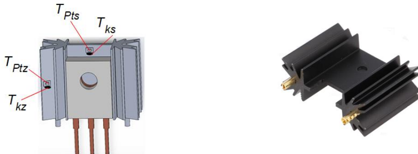
Rysunek 78: Radiator SK 104 25,4 STC o rezystancji termicznej 14 K/W z tranzystorem C2M0280120.
