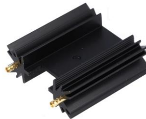
Rysunek 77: Radiator SK 104 38,1 STC o rezystancji termicznej 11 K/W z tranzystorem IRF 9540 (lub IRF 9640).
