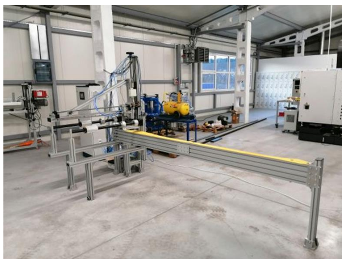
Rys. 92. Widok ogólny wdrożonej maszyny do nakładania natryskowego kleju na kompozytowe pasy transportujące znajdującej się w siedzibie przedsiębiorstwa WHM Müller w Bydgoszczy
