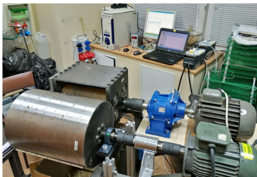
Rys. 23. Widok ogólny stanowiska do badań procesu cięcia biomasy [5]
