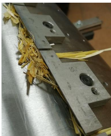
Rys. 35. Efekt wciskania słomy pod ostrze noża [5]
