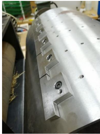
Rys. 24. Widok ogólny na obrotowy bęben z przymocowanymi nożami [5]
