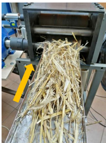
Rys. 27. Widok na odważoną próbkę słomy przed wsunięciem jej w przestrzeń wałów wciągających [5]
