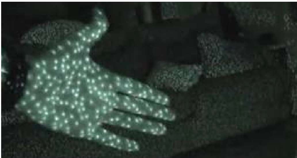
Rysunek 2.4: Emitowane przez Kinecta punkty widziane za pomocą noktowizora [7]
