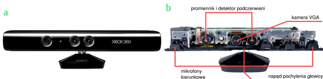
Rysunek 2.3: a) Kinect_v1 w obudowie [3] b) Schemat urządzenia [149]
