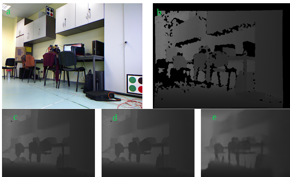
Rysunek 6.38: a) Oryginalny obraz RGB, Mapy głębi: b) oryginalna, c) Navier-Stokes(NS) d) Telea, e) inferencja sieci Monodepth douczonej na podstawie danych RGB-D
