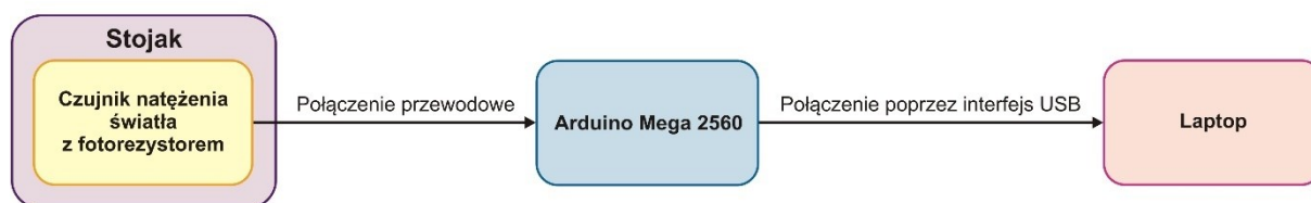
Rys. 5.5. Schemat blokowy układu akwizycji danych z czujników pomiarowych
