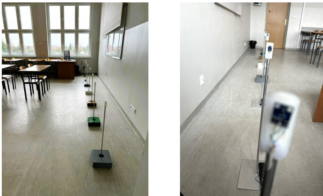
Rys. 5.14. Bezprzewodowa matryca pomiarowa w miejscu wykonywania badań
