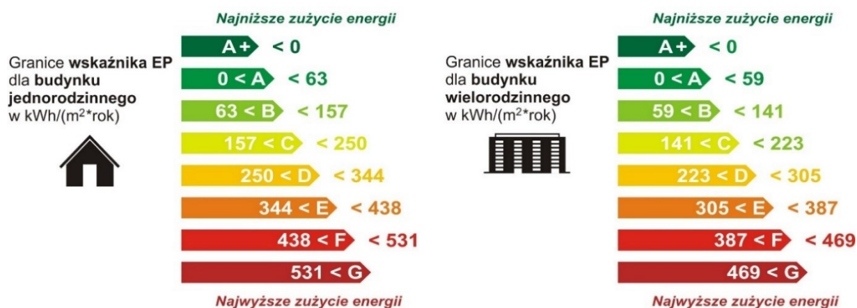
Rys. 2.1. Podstawowe obszary oszczędności wpływające na efektywność energetyczną wraz z wydzielonymi klasami energetycznymi dla budynków
