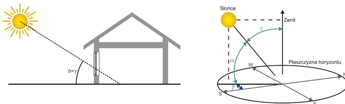
Rys. 2.3. Kąty wyznaczające położenie Słońca względem obserwatora: \tau – kąt zenitalny, \alpha – kąt wzniesienia Słońca, \gamma – kąt azymutalny Słońca
