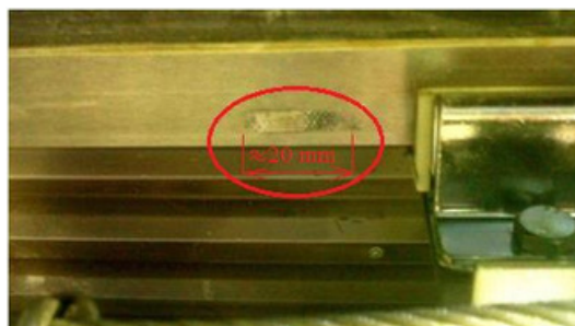
Rys. 4.8. Porównanie wyników: a) symulacji MES, b) eksperymentu hamowania dla chwytacza CHP2000
