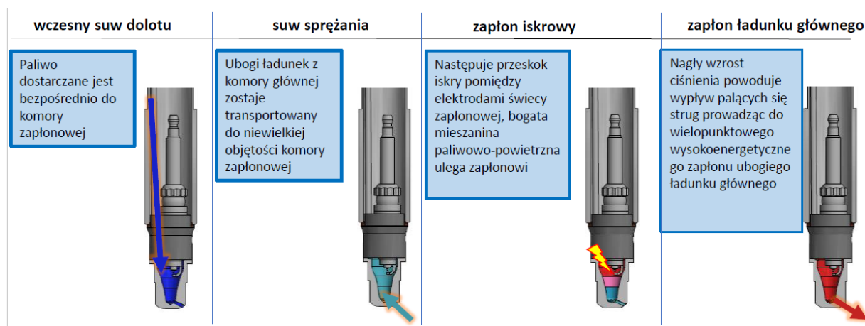
Rys. 3.3. Wybrane procesy cyklu pracy czterosuwowego silnika gazowego z aktywnym systemem spalania dwustopniowego
