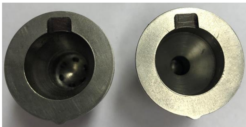
Rys. 5.6. Widok wykonanych komór przed montażem
