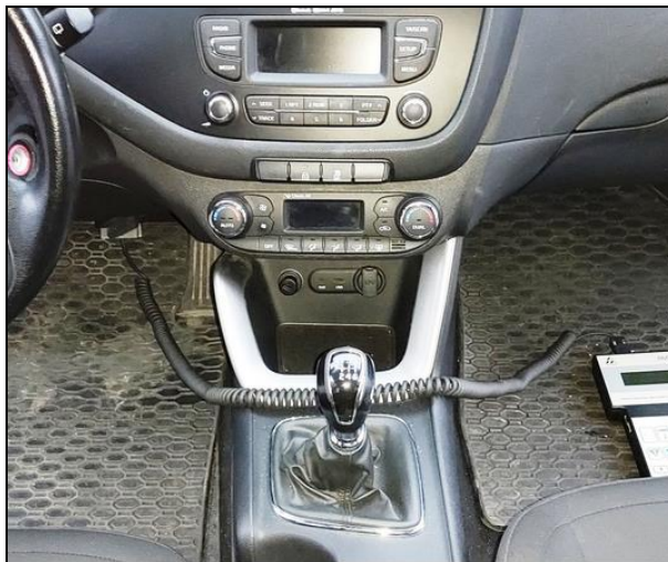
Rys. 4.8. Widok wnętrza pojazdu Renault Master z zamontowanym opóźniomierzem AMX 520
