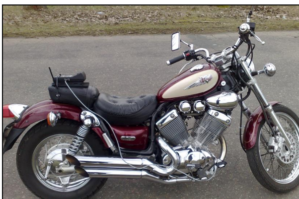
Rys. 4.11. Motocykl Yamaha Virago z zamontowanym opóźniomierzem OP-1 ELHOS
