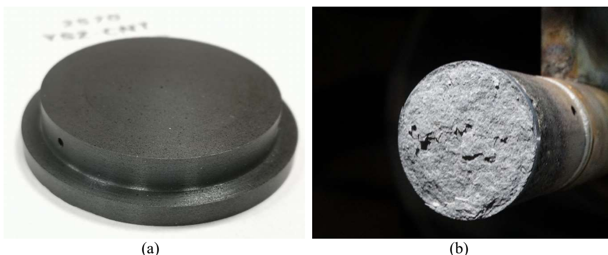
Rys. 9. Próbkki 3YSZ-MWCNT testowane w tunelu w DLR: próbka przed testem (a), próbka po teście (b), zdjęcia dzięki uprzejmości DLR
