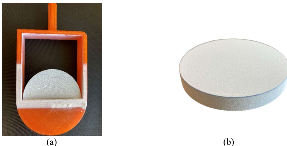
Rys. 10. Uchwyt do zamocowania demonstratora w trakcie procesu natryskiwania (a), demonstrator wykonany z 3YSZ–MWCNT z nałożoną powłoką 8YSZ (b)
