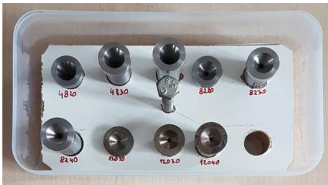
Rys. 75. Dysze z kanałem zbieżnym
