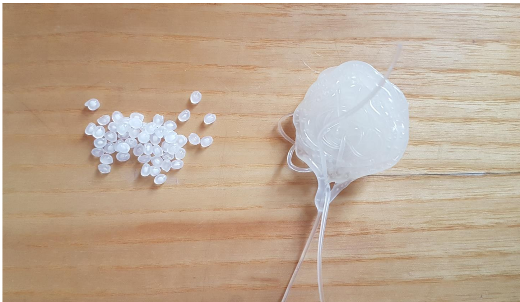
Rys. 80. Materiał badany w reometrze (z lewej granulki – umieszczone w reometrze, z prawej – materiał wypływający z reometru)
