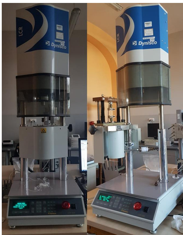
Rys. 72. Reometr kapilarny firmy Dynisco z czujnikiem ciśnienia – Politechnika Bydgoska
