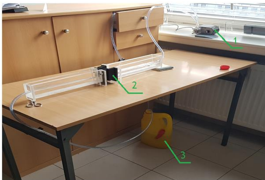
Rys. 20. Stanowisko pomiarowe do wizualizacji przy wykorzystaniu opiłków proszku aluminiowego (1 – pompa, 2 – sekcja badawcza, 3 – zbiornik cieczy)
