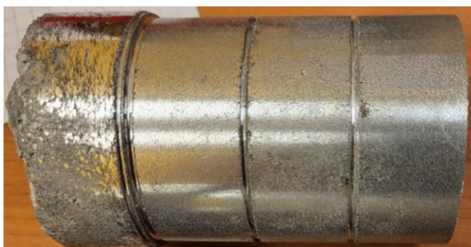
Rys. 41. Odlew kompozytowy o 3,66%-owej zawartości włókna glinokrzemianowego w zbrojeniu przeznaczony do badań skrawalności: a) surowy odlew, b) po obróbce wstępnej.
