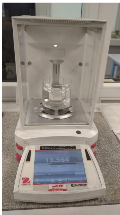
Rys. 31. Waga laboratoryjna z umieszczoną próbką.
