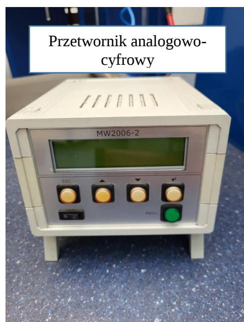
Rys. 43. Widok stanowiska badawczego do przeprowadzania prób toczenia: a) komora obróbcza tokarki CNC DMG CTX 310 ECOLINE z zamontowanym na głowicy narzędziowej siłomierzem tokarskim, b) siłomierz tokarski z zamontowaną płytką skrawającą stosowaną podczas badań, c) przetwornik analogowo-cyfrowy podłączony do komputera wyposażonego w oprogramowanie do analizy sił skrawania.
