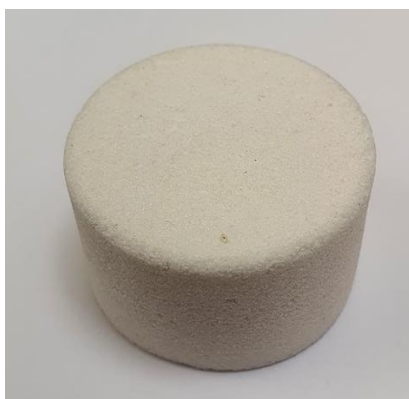
Rys. 47. Widok kształtki ceramicznej poddanej procesowi wyżarzania.
