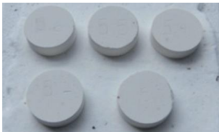
Rys. 19. Widok walcowatych kształtek ceramicznych po procesie spiekania [71].
