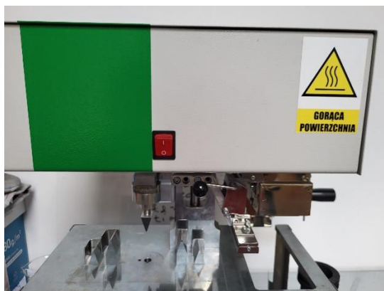
Rys. 36. Widok stanowiska do badania zjawisk hot-distortion oraz wytrzymałości na zginanie.
