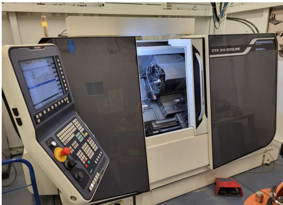
Rys. 42. Widok stanowiska badawczego do toczenia kompozytu.
