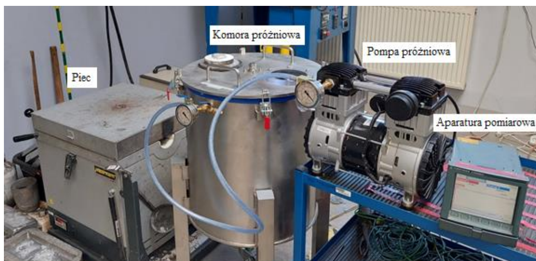
Rys. 35. Stanowisko do odlewania podciśnieniowego.
