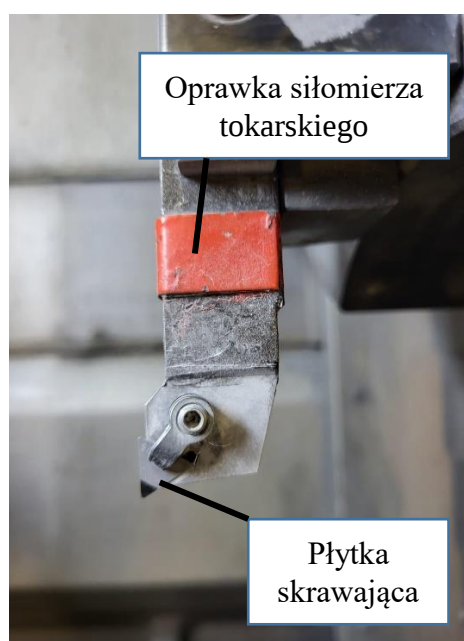
Rys. 43. Widok stanowiska badawczego do przeprowadzania prób toczenia: a) komora obróbcza tokarki CNC DMG CTX 310 ECOLINE z zamontowanym na głowicy narzędziowej siłomierzem tokarskim, b) siłomierz tokarski z zamontowaną płytką skrawającą stosowaną podczas badań, c) przetwornik analogowo-cyfrowy podłączony do komputera wyposażonego w oprogramowanie do analizy sił skrawania.
