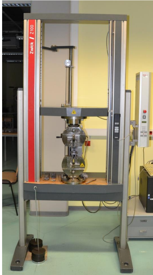
Rys. 37. Maszyna wytrzymałościowa Zwick/Z100.
