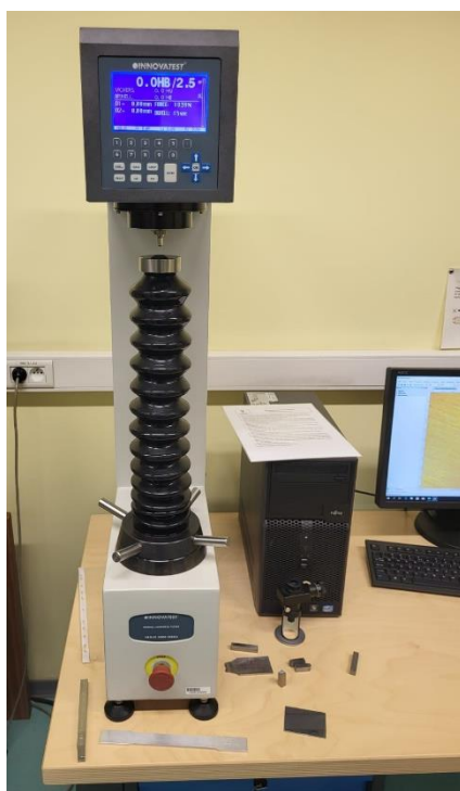
Rys. 40. Widok stanowiska do przeprowadzania pomiarów twardości.
