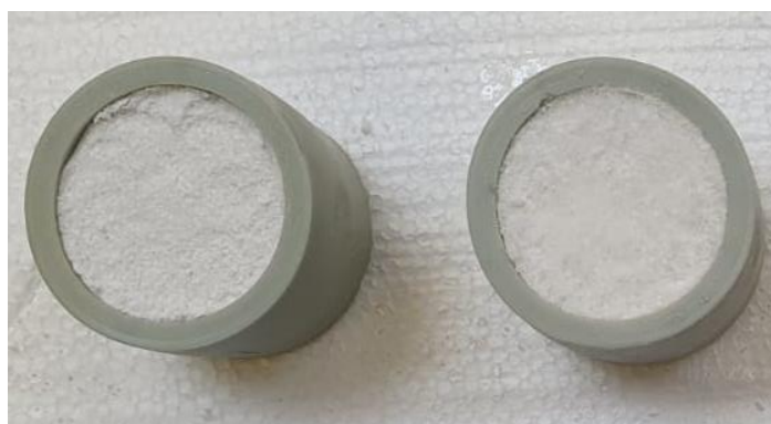
Rys. 32. Widok sprasowanej masy ceramicznej w silikonowych formach.
