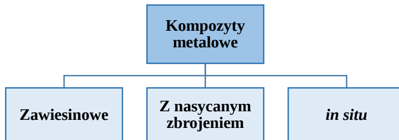
Rys. 5. Podział kompozytów metalowych ze względu na metodę wytwarzania (opracowanie własne na podstawie [70, 137, 153]).
