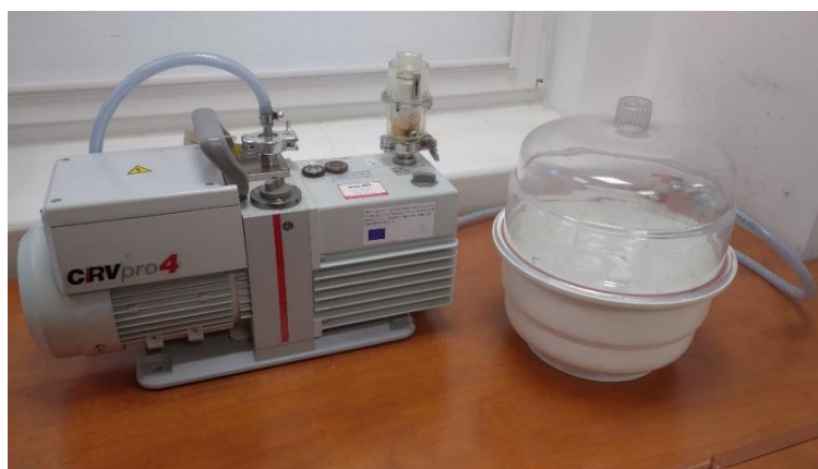
Rys. 30. Widok stanowiska do podciśnieniowego nasycania próbek wodą.
