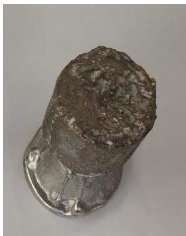
Rys. 48. Kształtka ceramiczna nasycona ciekłym stopem Al.
